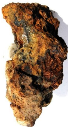
Erzproben: Fundstelle Rahlsbach, Schaliges Brauneisenerz Die chemische Analyse ergab 55% Eisengehalt
